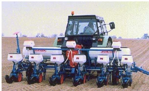
**Figura 2.** Sembradora neumática de precisión
